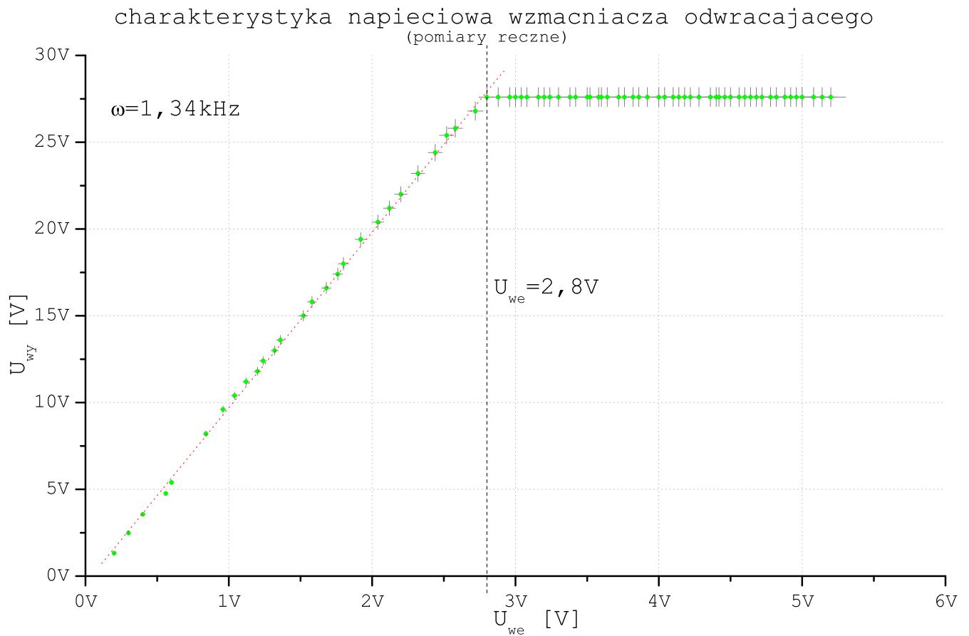
Rysunek 4: Charakterystyka napięciowa wzmacniacza odwracającego
